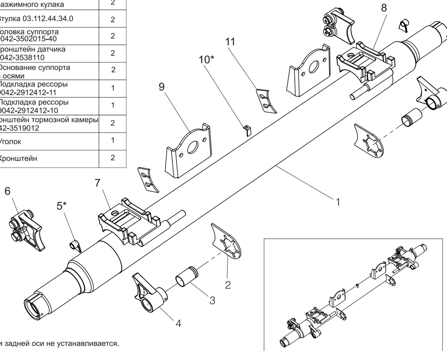
\* Деталь поз.11 на балках передней и задней оси не устанавливается.
